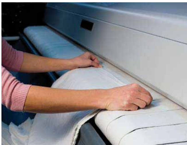
La protezione delle mani con doppio sensore controlla la posizione attiva e di riposo.
